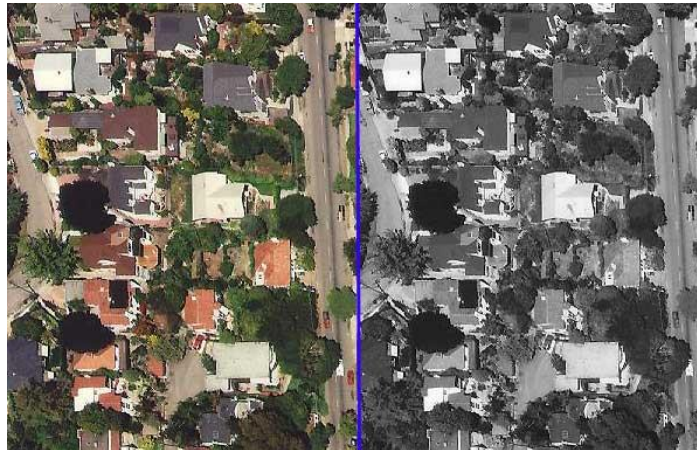
Gambar 11. Perbandingan Foto Udara Pankromatik Berwarna dan Hitam Putih
