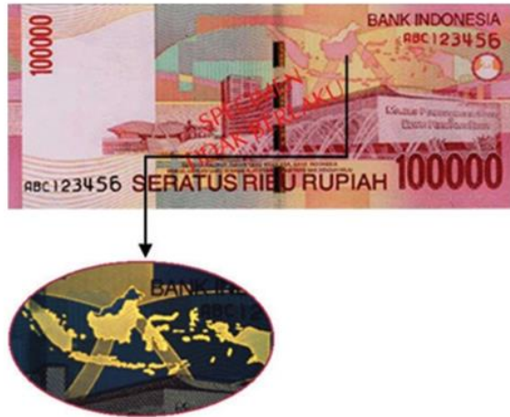
Gambar 22 Visible Ink pada Pecahan Rp100.000,00
