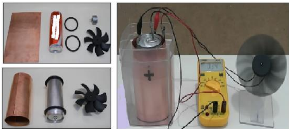
Gambar 6. Uji terbatas sel Volta dari garam dapur
