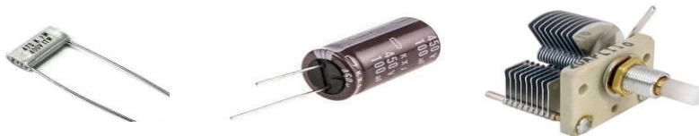
Gambar 14. Kapasitor kertas, eektrolit dan variabel
