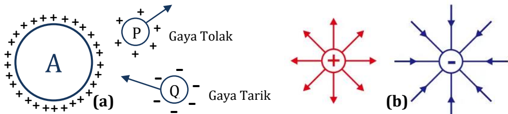
Gambar 5. (a) Gaya listrik yang bekerja pada muatan-muatan yang diletakkan dalam ruang di sekitar muatan sumber A. (b) Garis khayal arah medan listrik, arah gaya listrik muatan positif ke luar, dan muatan negatif ke dalam.
